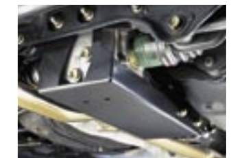
32 ★ W Differenzialschutz B031SSA000 Zum Schutz des hinteren Differenzials vor Beschädigungen.
