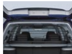
60 ★ W Laderaumtrenngitter F551ESA000 Trennt den Laderaum vom Insassenbereich, auch bei Verwendung von ISOFIX-Kindersitzen geeignet.
